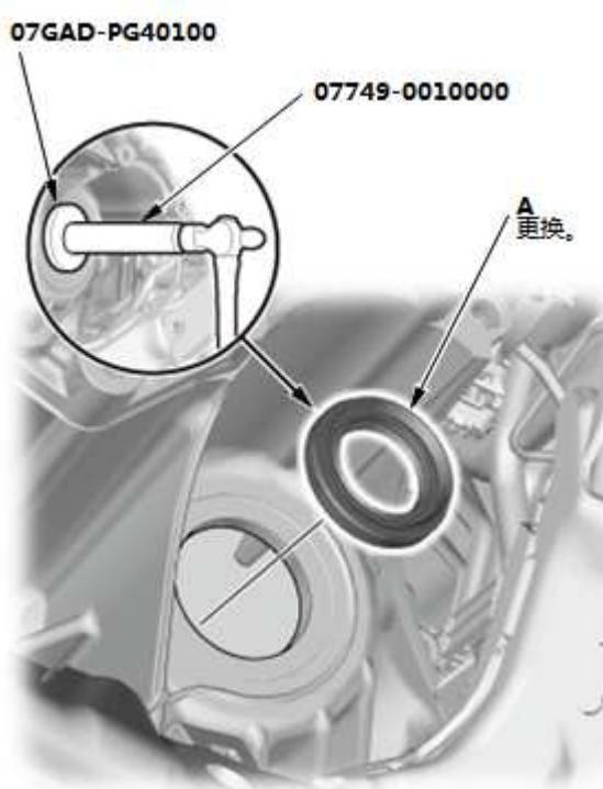
1. 用 15 x 135L 拆装器手柄和油封拆装器附件安装半轴油封 (A)，使其与变速箱壳体平齐。
